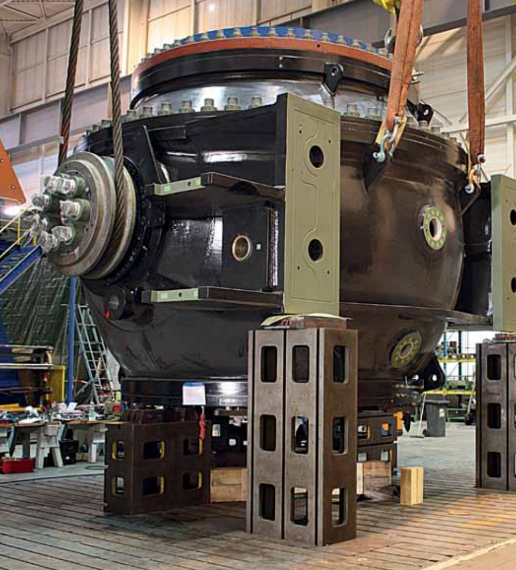
▲ Válvula esférica para a UHE de Herdecke durante montagem na oficina
