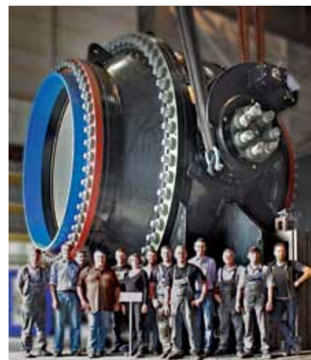
▲ Válvula esférica para a UHE de Herdecke: a conclusão dos testes de vedação
