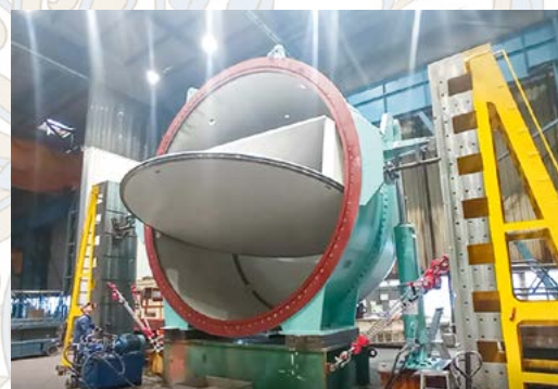
Заводские приемные испытания затвора на заводе ANDRITZ в Венгрии
