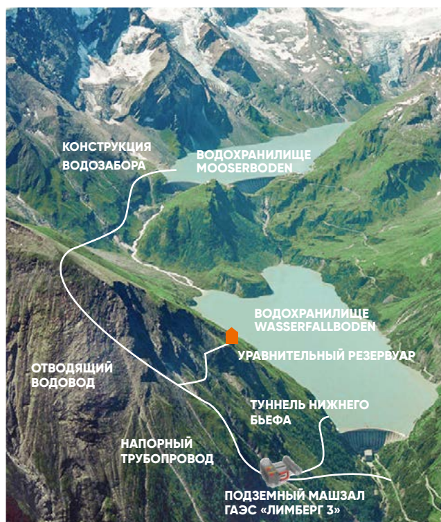
Схема ГАЭС «Лимберг 3», которой владеет и управляет компания «VERBUND».
