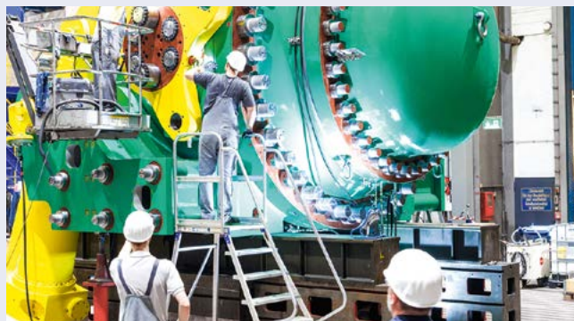
Испытания под давлением и заводская приемка первого из шести шаровых затворов для ГАЭС «Динорвиг» в присутствии заказчика осенью 2022 года
